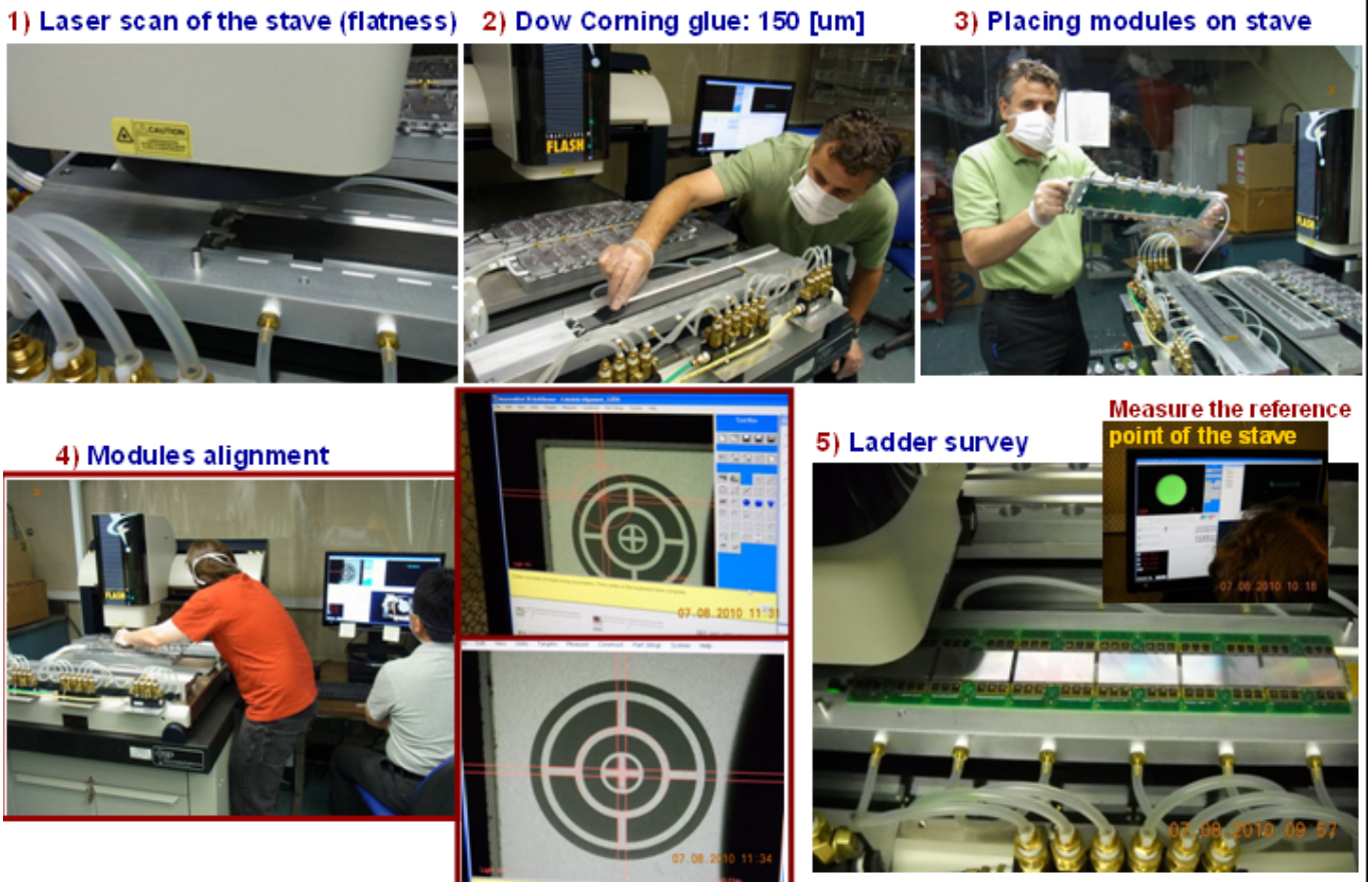
Figure IV.45: Etapes d'assemblage du ladder silicium stripixel dans la phase de production
