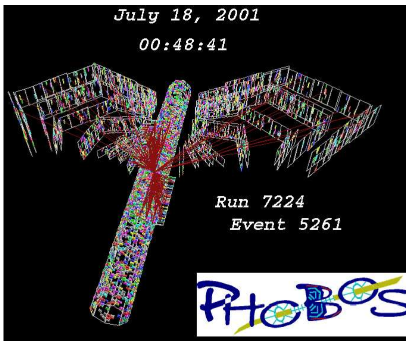
Figure IV.6: Distribution des hits (particules chargées) pour un évènement observé dans le détecteur PHOBOS lors de la première collisions Au + Au à \sqrt{s_{NN}} = 200 GeV.
