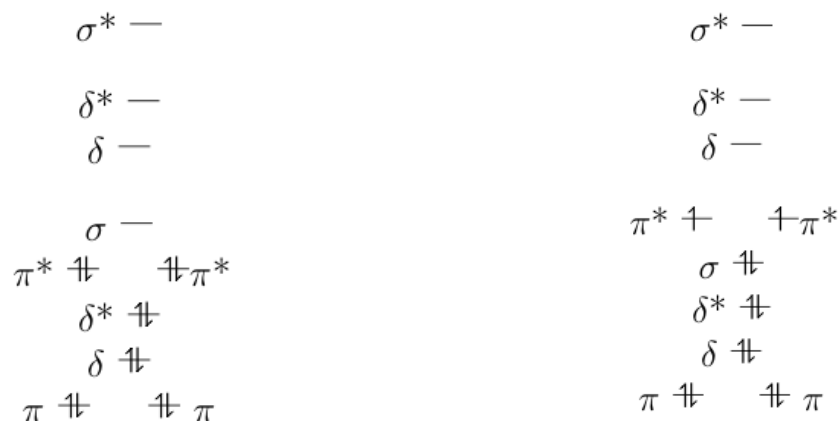
Figure 8 : Schéma orbitalaire simplifié du singulet couche fermée (à gauche) et du triplet (à droite) du complexe de [\text{Ru}_2(\text{napy})_4(\text{Cl})_2]^{2+} . Seules les interactions entre les orbitales d de chaque cation sont représentées. 21
