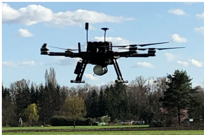
FIGURE 50 – Gauche : spectre typique de mesure de la radioactivité environnementale par drone ; Droite : système de détection développé dans le cadre du projet MERCURE.
