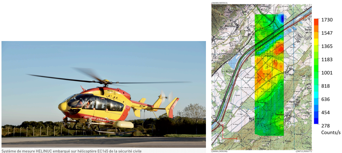
FIGURE 38 – Gauche : exemple de système de mesure aéroporté ; Droite : cartographie de la radioactivité environnementale [129]
