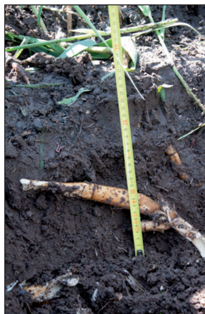
Figure 6. Coupe de l'horizon de dépôt sur le 1 er étage du filtre (site A)
