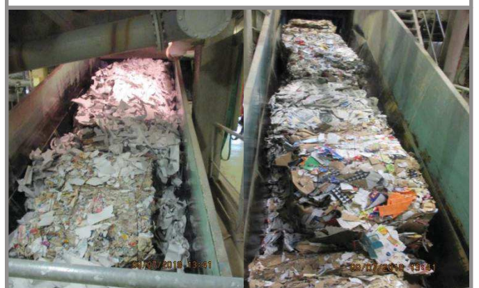
Alimentation en balles de la préparation continue
