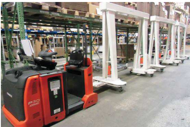
Figure 2 Photo d'un Milk-run grand contenant reliant le magasin de stockage aux lignes de montage. Source : Base de données Gaggenau
