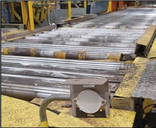
**Capteurs de mouvement présents au niveau des convoyeurs et similaires à ceux commandés pour installation dans la zone.**
