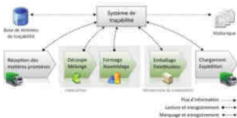
FIGURE 10. SCHEMA D'UN SYSTEME DE TRAÇABILITE (TAMAYO GIRALDO, 2011)
