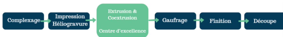
Figure VIII – Processus de fabrication sur le site Amcor Flexibles Sélestat
