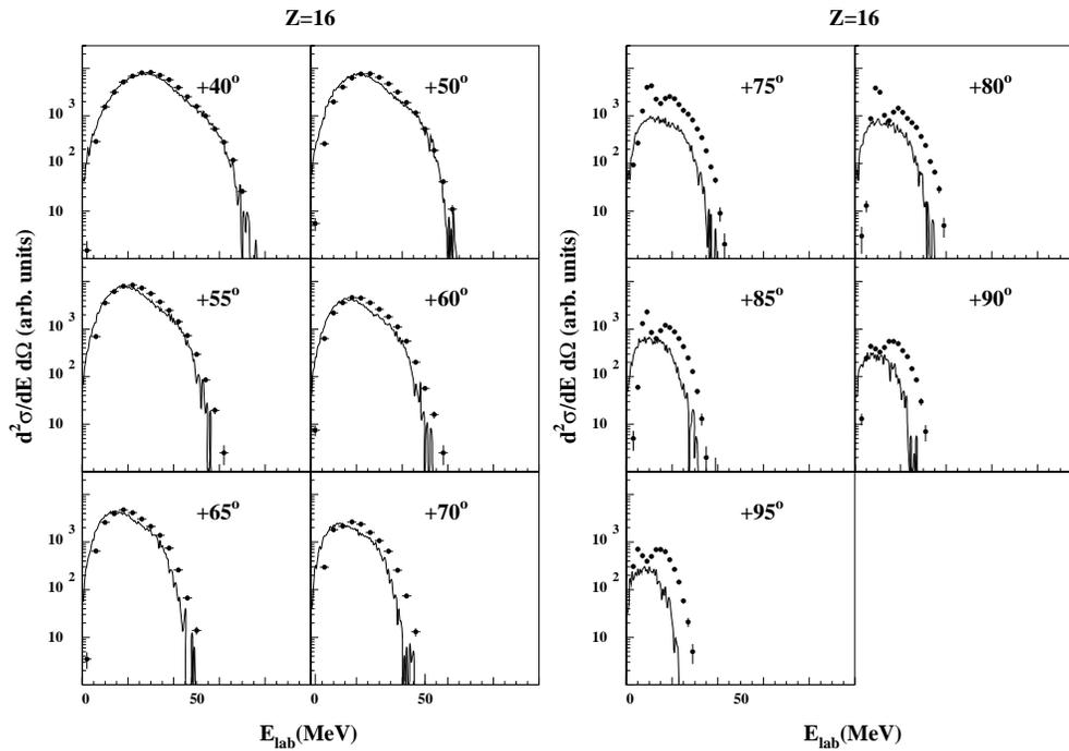
FIG. 4.14: Spectres en énergie des particules  $\alpha$  détectées à différents angles en coïncidence avec le Soufre détecté à  $10^\circ$  du côté opposé par rapport à l'axe du faisceau incident pour la réaction  $^{28}\text{Si}(E_{\text{lab}}=180 \text{ MeV}) + ^{12}\text{C}$ . Les lignes pleines correspondent aux calculs effectués par CACARIZO avec  $\delta_1=2.5 \cdot 10^{-4}$  et  $\delta_2=5 \cdot 10^{-7}$ .
