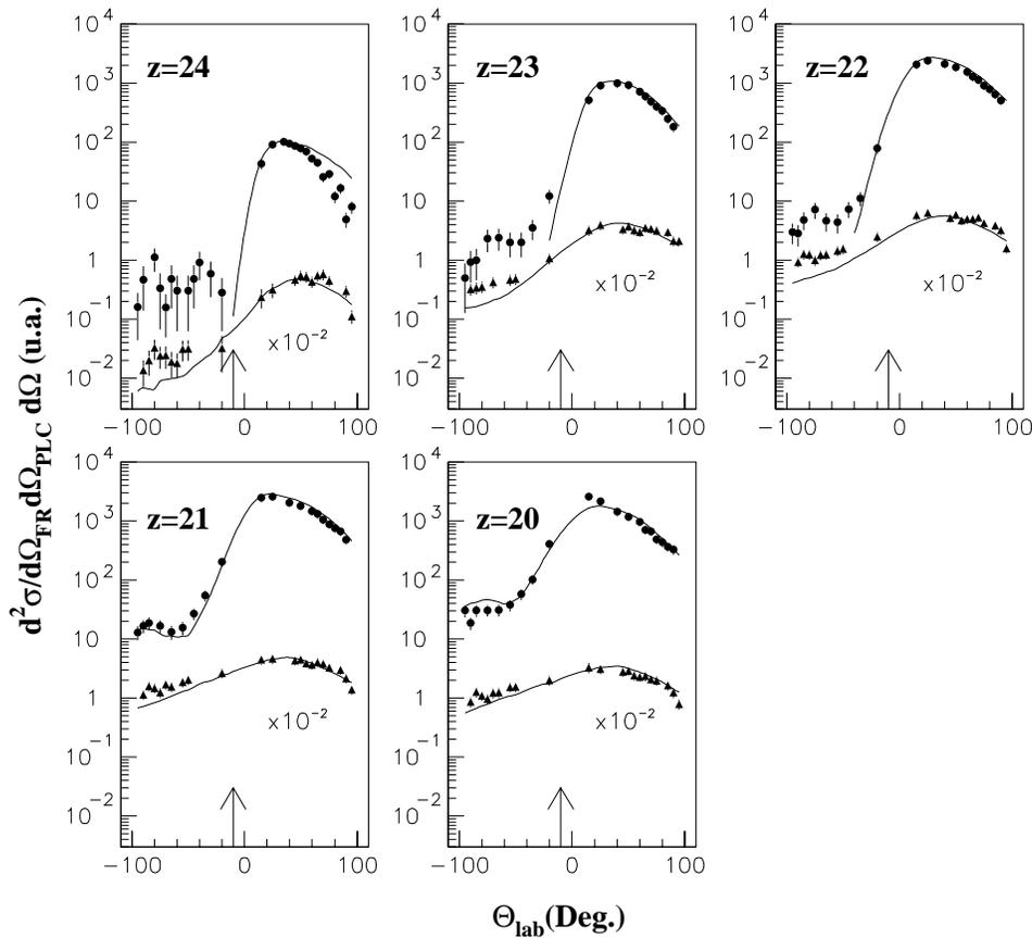
FIG. 4.11: *Corrélations angulaires dans le plan des protons (triangles) et des particules  $\alpha$  (cercles) en coïncidence avec différents résidus d'évaporation détectés à  $-10^\circ$  dans la réaction  $^{28}\text{Si}(E_{\text{lab}}=180 \text{ MeV})+^{28}\text{Si}$ . Les courbes représentent les données simulées par le code CACARIZO.*
