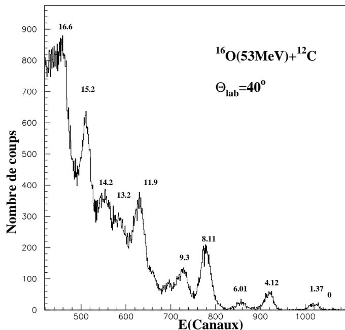
FIG. 2.15: Spectre  $\alpha$  de la réaction  $^{12}\text{C}(^{16}\text{O}, ^4\text{He})^{24}\text{Mg}^*$  obtenu dans le scintillateur d'un télescope à  $40^\circ$ . Les énergies d'excitation des états du noyau  $^{24}\text{Mg}^*$  sont données en MeV.
