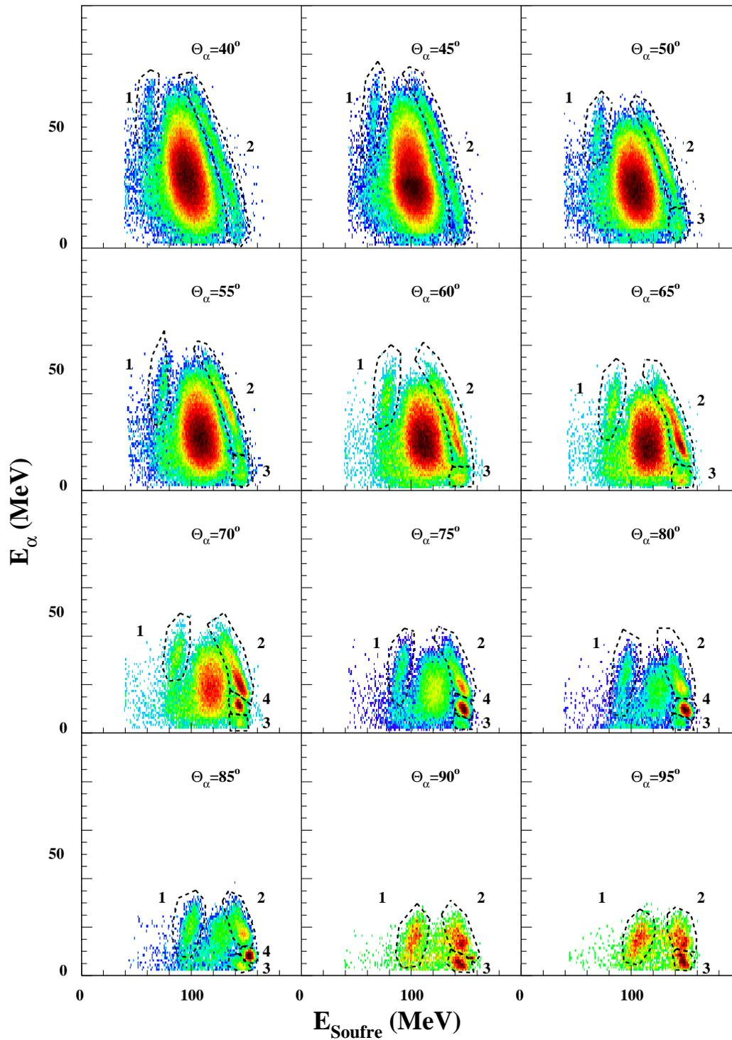
FIG. 4.20: Spectres bidimensionnels énergie alpha vs énergie Soufre obtenus dans la réaction  $^{28}\text{Si}(E_{lab}=180 \text{ MeV})+^{12}\text{C}$ . Les particules alphas sont détectées aux angles indiqués, les résidus d'évaporation sont détectés à  $10^\circ$  du côté opposé par rapport à l'axe du faisceau. Les lignes pointillées et les chiffres correspondent aux différentes composantes discutées dans le texte.
