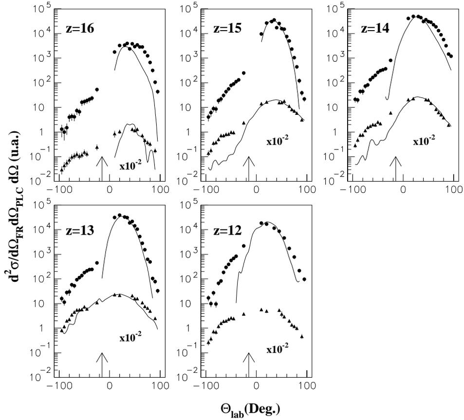
FIG. 5.3: *Corrélations angulaires dans le plan des protons (triangles) et des particules  $\alpha$  (cercles) en coïncidence avec différents résidus d'évaporation détectés à  $-15^\circ$  dans la réaction  $^{28}\text{Si}(E_{\text{lab}}=180 \text{ MeV})+^{12}\text{C}$ . Les courbes représentent les données simulées par le code CACARIZO.*
