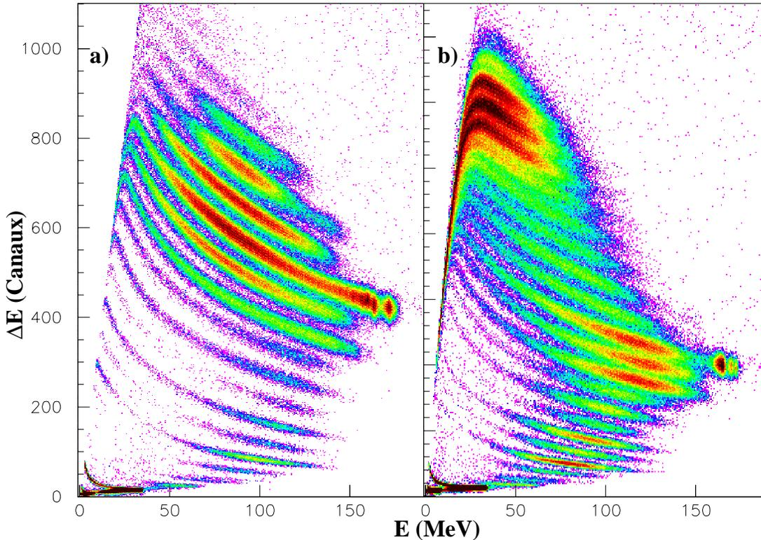
FIG. 2.12: Spectres bidimensionnels  $\Delta E(\text{Canaux})-E_{\text{totale}}(\text{MeV})$ . a) réaction  $^{28}\text{Si}+^{12}\text{C}$  à  $E_{\text{lab}}=180 \text{ MeV}$ ,  $\theta_{\text{lab}}=10^\circ$  b) réaction  $^{28}\text{Si}+^{28}\text{Si}$  à  $E_{\text{lab}}=180 \text{ MeV}$ ,  $\theta_{\text{lab}}=15^\circ$ .
