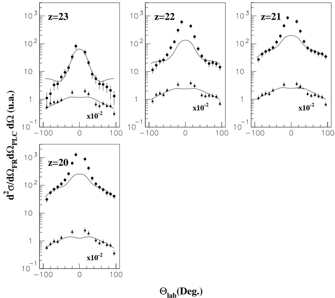
FIG. 4.12: *Corrélations angulaires hors-plan des protons (triangles) et des particules  $\alpha$  (cercles) en coïncidence avec différents résidus d'évaporation détectés à  $10^\circ$  dans la réaction  $^{28}\text{Si}(E_{lab}=180 \text{ MeV})+^{28}\text{Si}$ . Les courbes représentent les données simulées par le code CACARIZO.*
