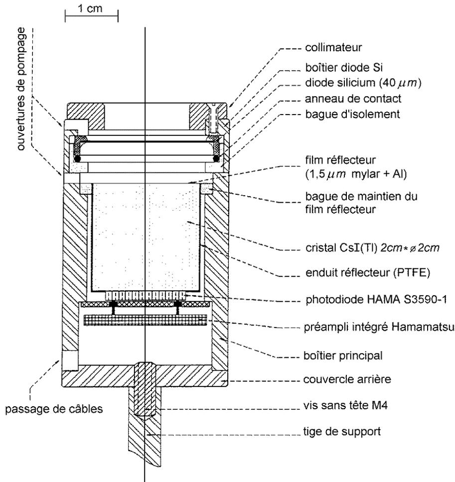
FIG. 2.3: Schéma d'un détecteur TL2 ( $\Delta E_{Si} - E_{CsI(Tl)}$ ).
