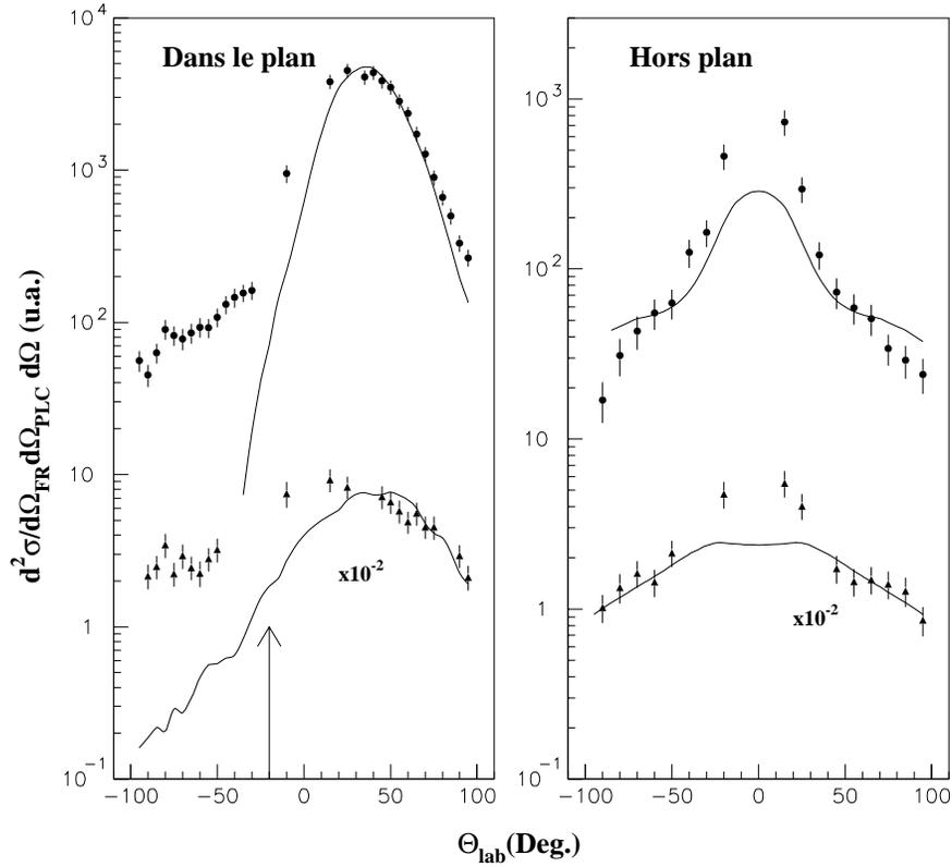
FIG. 5.2: *Corrélations angulaires dans le plan (Figure de gauche) et hors plan (Figure de droite) des protons (triangles) et des particules  $\alpha$  (cercles) en coïncidence avec tous les résidus d'évaporation détectés respectivement à  $-20^\circ$  (dans le plan) et  $20^\circ$  (hors plan) dans la réaction  $^{28}\text{Si}(E_{\text{lab}}=180 \text{ MeV})+^{28}\text{Si}$ . Les courbes représentent les données simulées par le code CACARIZO.*
