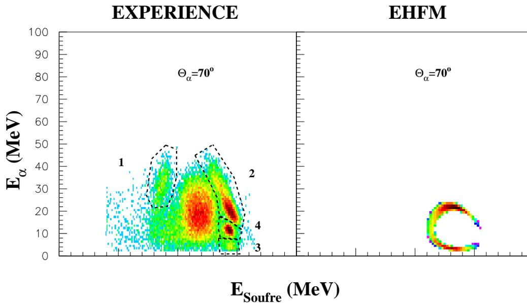
FIG. 4.25: Comparaison du spectre bidimensionnel énergie alpha vs énergie Soufre obtenu dans la réaction  $^{28}\text{Si}(E_{lab}=180 \text{ MeV})+^{12}\text{C}$  avec les simulations du code EHFM. Les particules alphas sont détectées à  $70^\circ$ , le Soufre est détecté à  $10^\circ$  du côté opposé par rapport à l'axe du faisceau.
