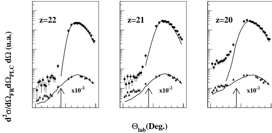
FIG. 5.1: *Corrélations angulaires dans le plan des protons (triangles) et des particules  $\alpha$  (cercles) en coïncidence avec différents résidus d'évaporation détectés à  $-15^\circ$  dans la réaction  $^{28}\text{Si}(E_{\text{lab}}=180 \text{ MeV})+^{28}\text{Si}$ . Les courbes représentent les données simulées par le code CACARIZO.*
