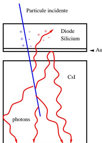
FIG. 2.16: Schéma du mécanisme provoquant une augmentation de la mesure de la perte d'énergie pour les particules légères les plus énergétiques dans l'expérience à  $E_{\text{lab}}(^{28}\text{Si})=111.6 \text{ MeV}$ .
