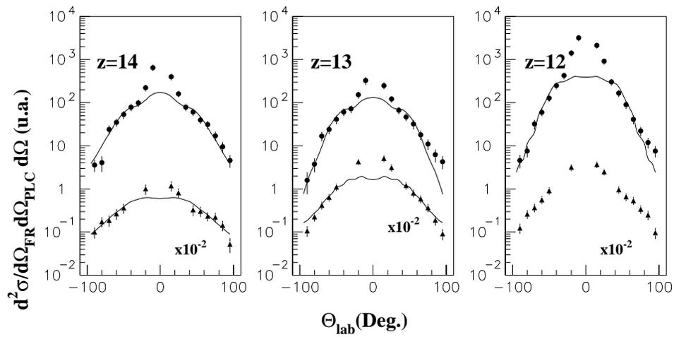
FIG. 5.5: *Corrélations angulaires hors-plan des protons (triangles) et des particules  $\alpha$  (cercles) en coïncidence avec différents résidus d'évaporation détectés à  $20^\circ$  dans la réaction  $^{28}\text{Si}(E_{\text{lab}}=180 \text{ MeV})+^{12}\text{C}$ . Les courbes représentent les données simulées par le code CACARIZO.*
