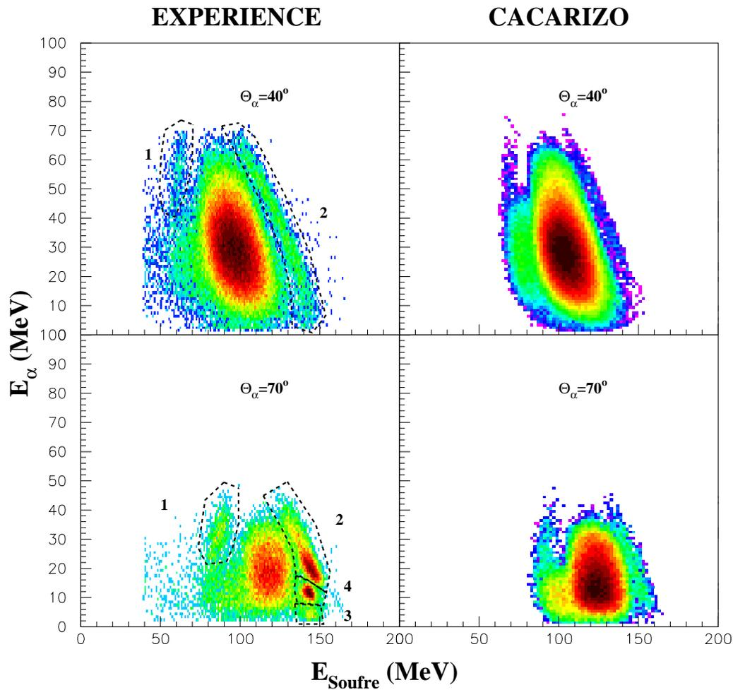
FIG. 4.21: Comparaison des spectres bidimensionnels énergie alpha vs énergie Soufre obtenus dans la réaction  $^{28}\text{Si}(E_{lab}=180 \text{ MeV})+^{12}\text{C}$  avec les données simulées par le code d'évaporation CACARIZO. Les particules  $\alpha$  sont détectées à  $40^\circ$  et  $70^\circ$ , le Soufre est détecté à  $10^\circ$  de l'autre côté par rapport à l'axe du faisceau.
