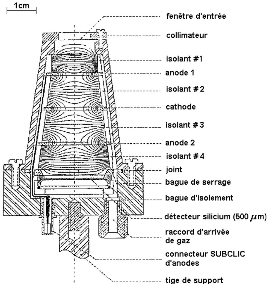
FIG. 2.2: Schéma d'un détecteur IC ( $\Delta E_{gaz} - E_{Si}$ ).
