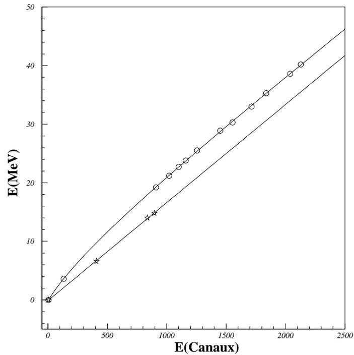
FIG. 2.17: Exemple type d'étalonnages établies pour un scintillateur placé à  $40^\circ$ . Les cercles correspondent aux points  $\alpha$ , les étoiles aux points protons. Les données ont été fittées suivant la relation 2.6.
