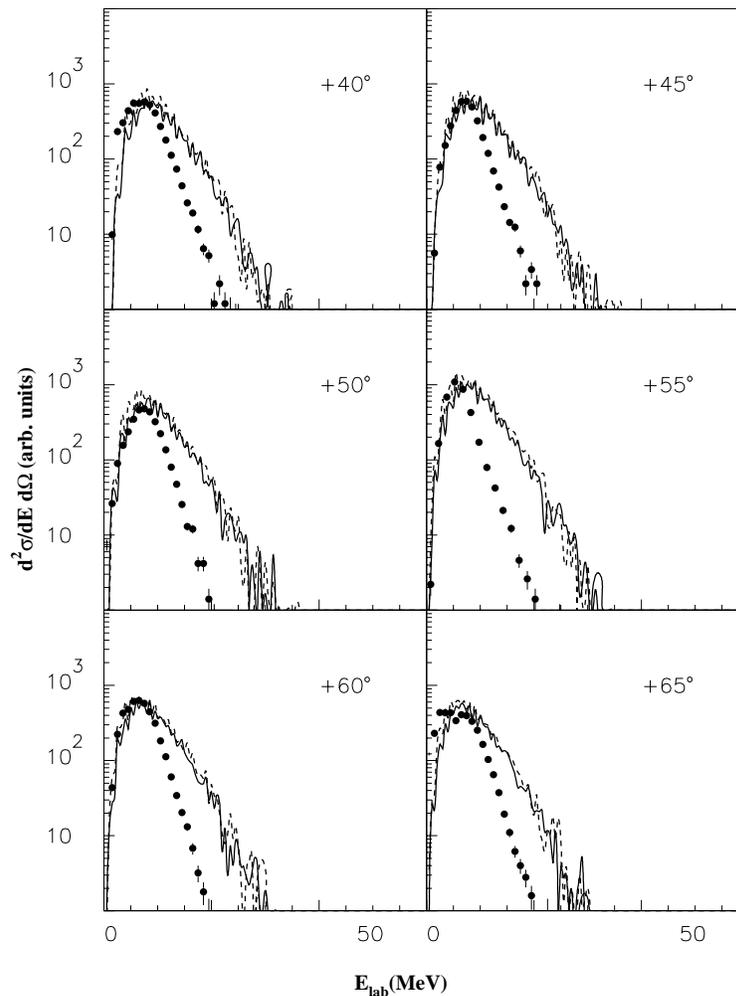
FIG. 4.9: Spectres en énergie des protons détectés à différents angles en coïncidence avec les résidus d'évaporation détectés à  $15^\circ$  du côté opposé par rapport à l'axe du faisceau incident pour la réaction  $^{28}\text{Si}(E_{lab}=111.6 \text{ MeV})+^{28}\text{Si}$ . Les lignes pleines et pointillées correspondent aux calculs effectués par CACARIZO pour deux jeux de paramètres discutés dans le texte.
