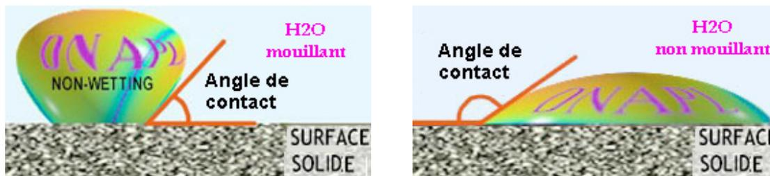
Figure A.2 : Contact eau/solvant chloré au voisinage d'une paroi solide.
