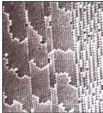
Figure 1. Vue en microscopie à balayage de la structure interne d'une opale naturelle (chaque bille a un diamètre d'environ 300 nm).
