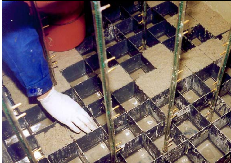
Figure 2-1 : Remplissage du modèle physique MARCEAUS avec des grilles de séparation.
