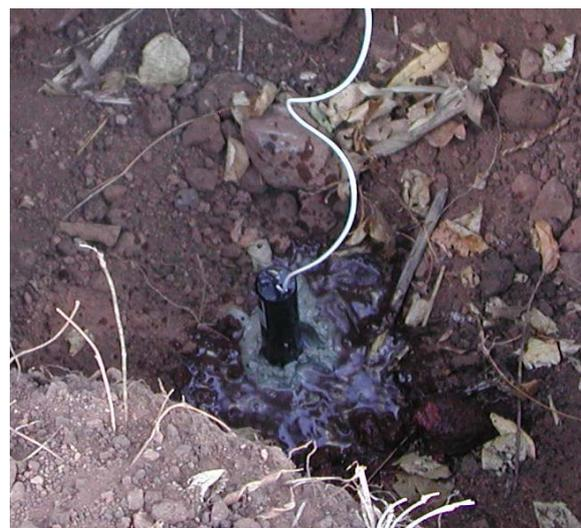
Fig. 2.5 – Mélange de bentonite et d'eau saturée en sel autour d'une électrode impolarisable
