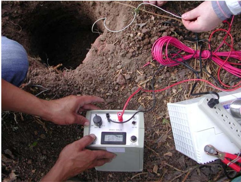
Fig. 2.6 – *Mesure de la différence de potentiel entre une électrode et une tige en acier pour tester la qualité du couplage électrique en le sol et l'électrode*
