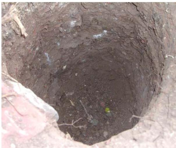
Fig. 2.4 – Cavité de 60 cm de profondeur et de 25 cm de diamètre servant à installer une électrode de suivi de PS sur une longue période.
