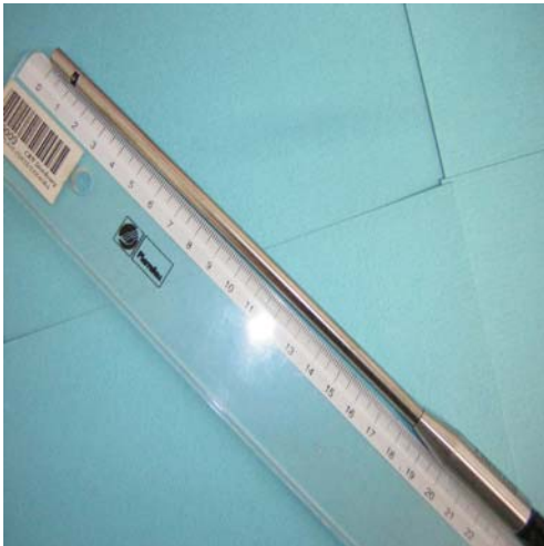
FIG. 4.2 – Sonde de mesure du dosimètre
