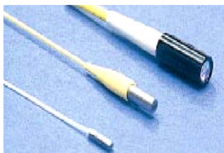
FIG. 3.3 – Têtes optiques ("Pigtail style focuser") servant à la collecte de la scintillation
