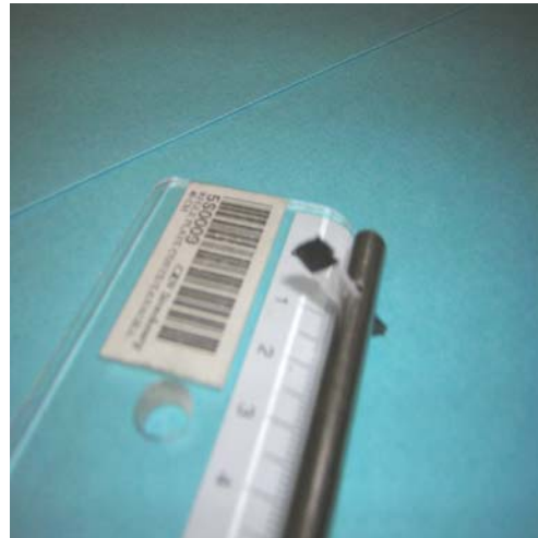
FIG. 4.3 – Sonde de mesure du dosimètre
