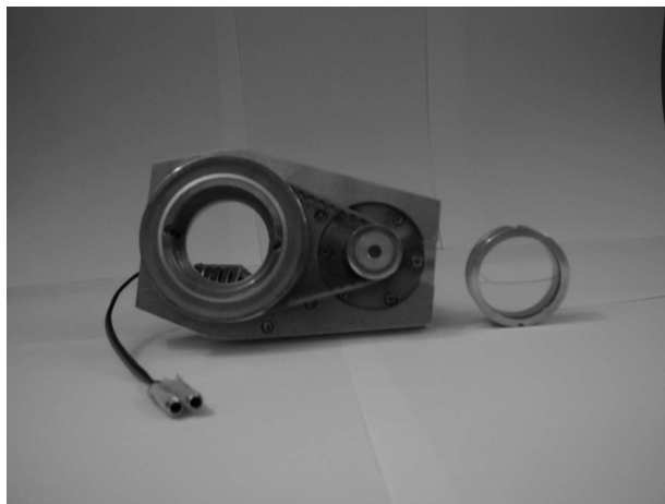
FIG. 2.27 – Cellule tournante utilisée dans les expériences pompe-sonde.
