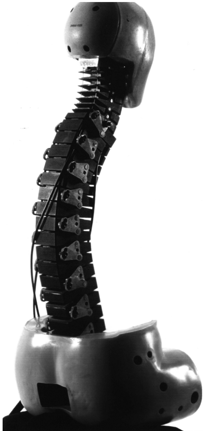
FIG. 2.18 – Construction de la colonne vertébrale de BioRID
