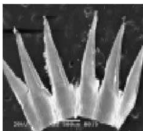
Figure 23 : Copeau et surface obtenus en coupe instable
