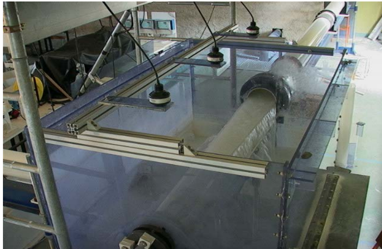
Figure 3-30 : Dispositif expérimental de mesure de débit avec les sondes ultrasons
