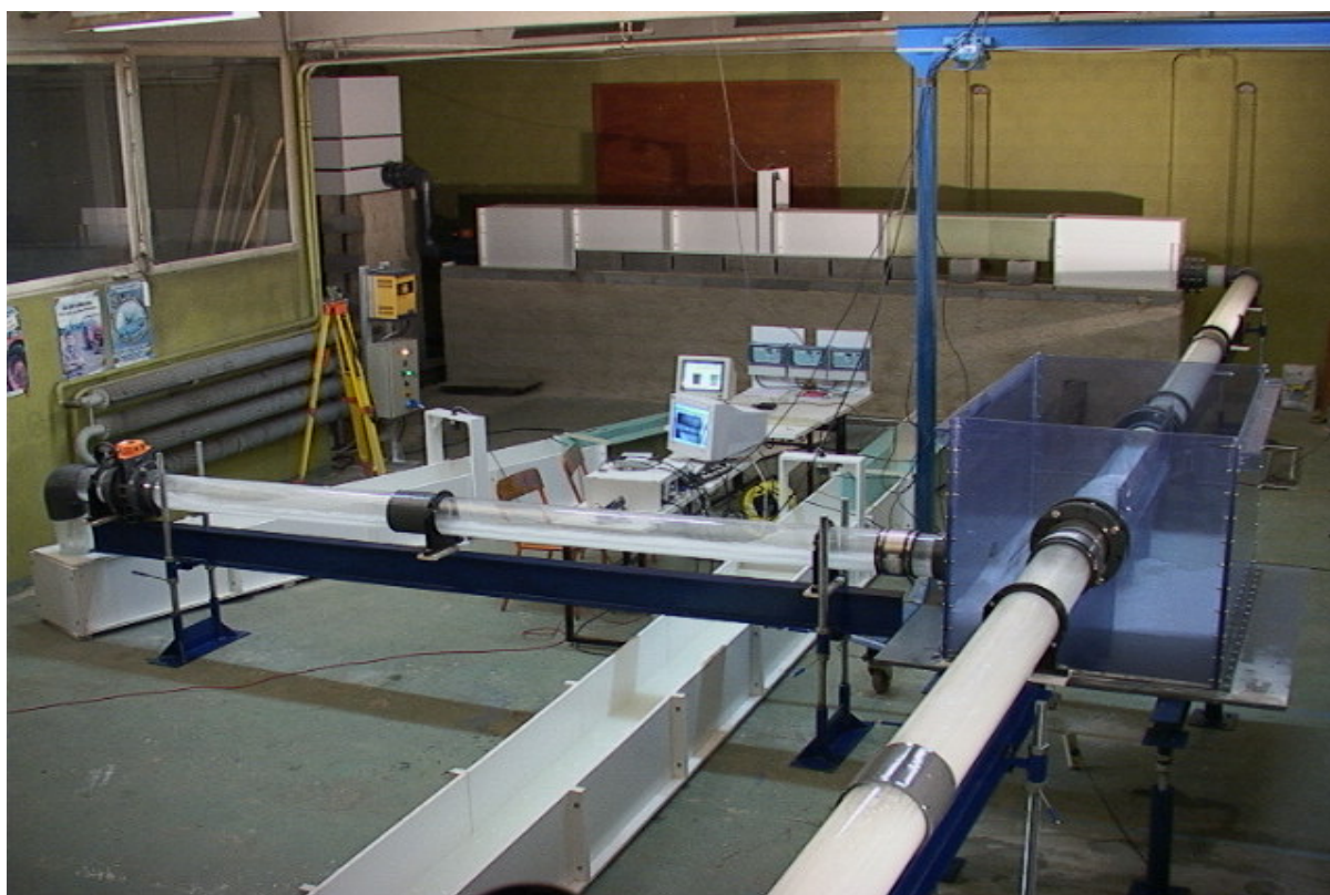
Figure 2-5 : Vue d'ensemble du pilote « déversoir d'orage »
