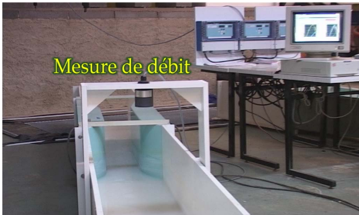
Figure 2-7 : Dispositif de mesure de débits
