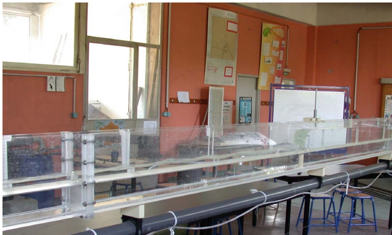
Figure 2-3 : Canal rectangulaire à surface libre
