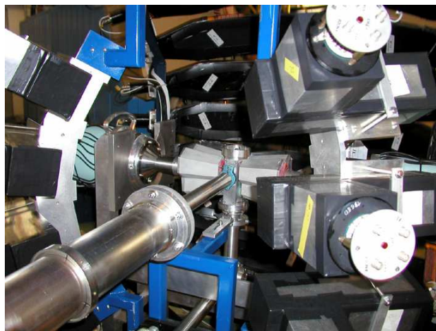
FIG. III.5 – Photographie du point de collection entourée des deux détecteurs MINIBALL et des détecteurs LEND situés de part et d'autre de la ligne de faisceau.
