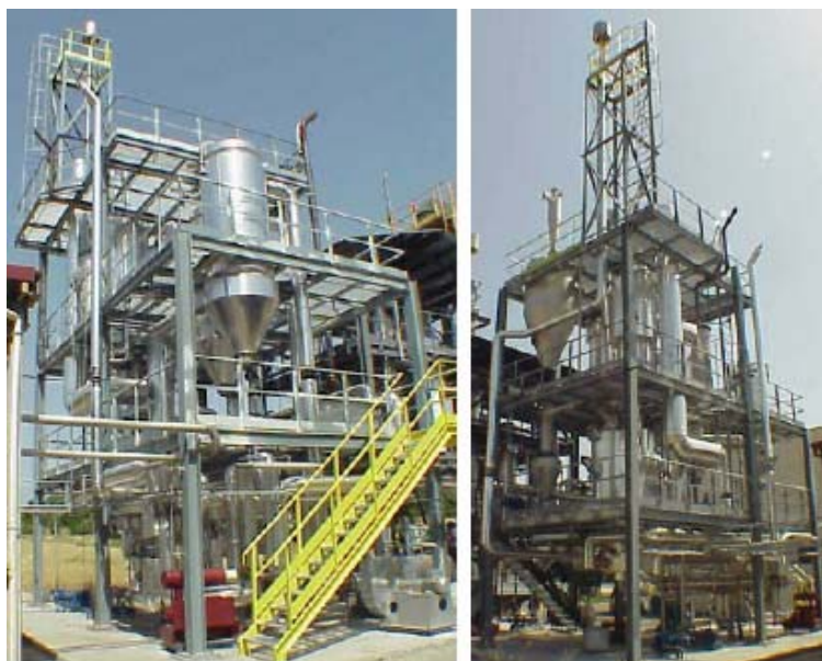
Figure 14. Unité pilote incluant un réacteur (FICFB) de gazéification de 500KWh, l'unité de purification du gaz et une pile à combustible au carbonate fondu de 125kWe (ENEA, Trisaia, Italie).
