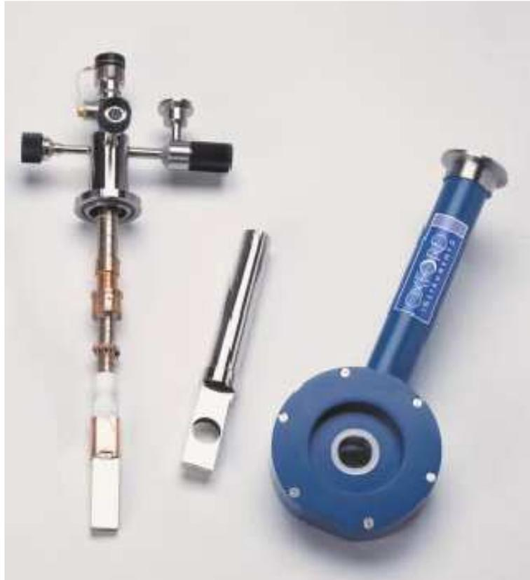
FIG. 2.9 – Éléments composants le microcryostat à flux d'hélium continu. De gauche à droite : le doigt froid, l'écran thermique et l'enceinte externe dont l'intérieur est mis sous vide.
