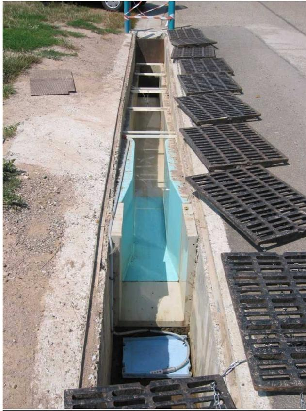
**Photo 5 : Appareil de mesure à l'exutoire du bassin versant (canal Venturi et prise de prélèvement)**
