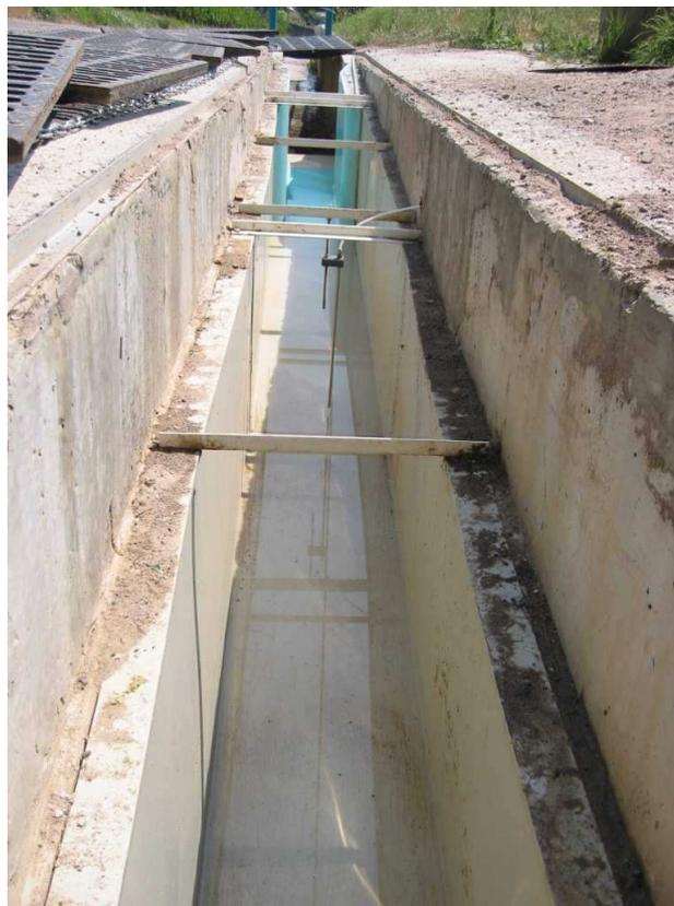
**Photo 6 : Mesure de la hauteur d'eau à l'exutoire du bassin versant par capteur de pression bulle à bulle**
