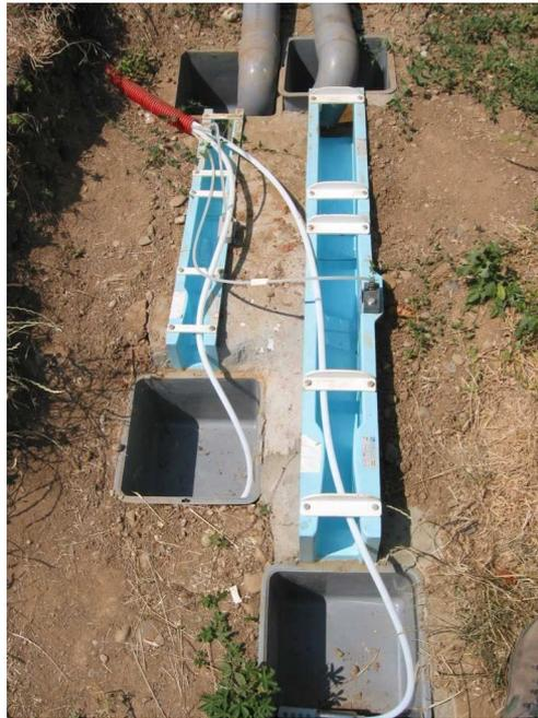
**Figure 2-23 : Canaux Venturi et prise de pression à l'exutoire des placettes**
