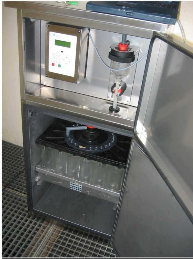
**Photo 7 : Préleveur réfrigéré à l'exutoire du bassin versant**
