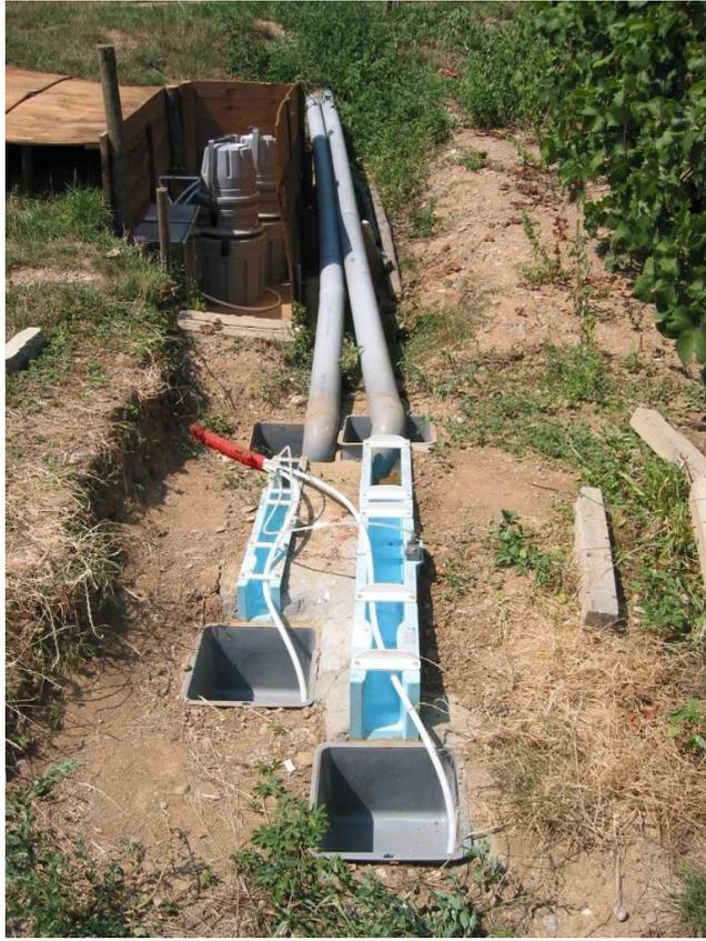
**Photo 3 : Appareil de mesure à l'exutoire des placettes (canaux Venturi, débitmètres et préleveurs)**
