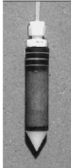
**Figure 2-30 : bougie en Téflon-quartz**
