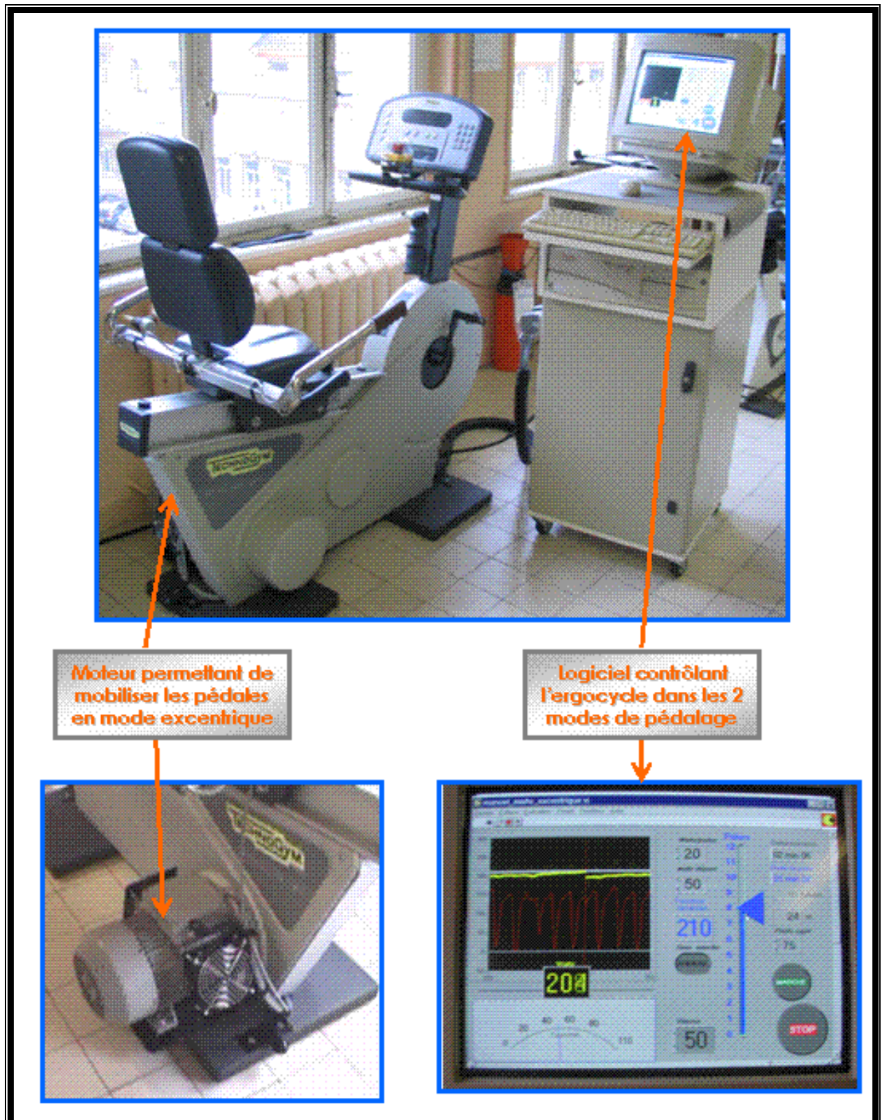
Figure 8: Prototype d'ergocycle excentrique développé au laboratoire. Un logiciel spécifique permet de contrôler le moteur additionnel nécessaire au fonctionnement de l'ergocycle dans les 2 modes de pédalage (concentrique et excentrique).
