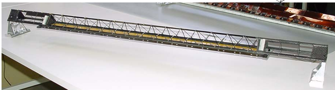
Figure 43 : Schéma et photo d'une échelle en carbone non équipée
