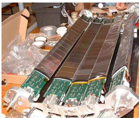
Figure 147 : Installation de 5 échelles sur le support métallique du SSD
