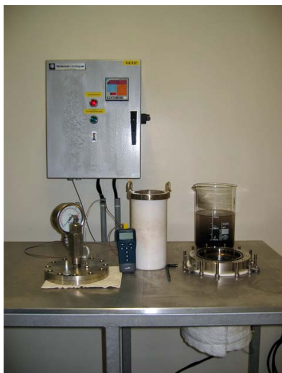
Figure II-11. Réacteur hydrothermal d'une contenance de 3l
