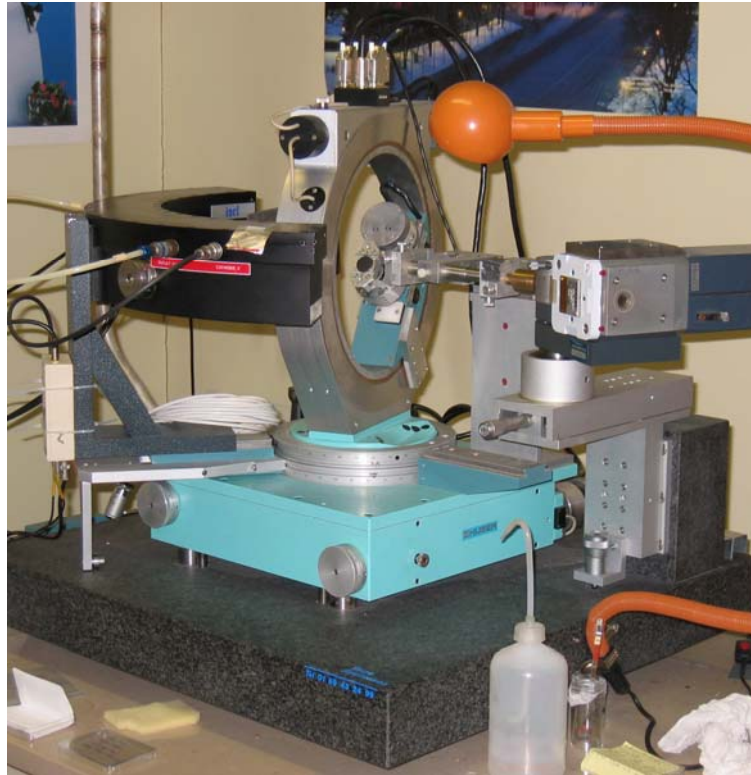
Figure IV-17. Dispositif expérimental utilisé pour l'acquisition des diagrammes RX en fonction de 2\theta et \chi
