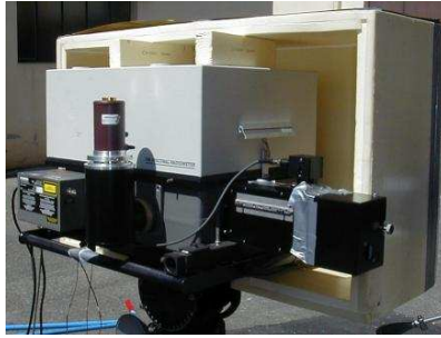
FIG. 3.7 - Isolation thermique du spectroradiomètre (coupe)
