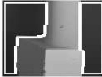
FIG. 2.4 – Contour de référence correspondant à une image de l'objet pale de turbine.
