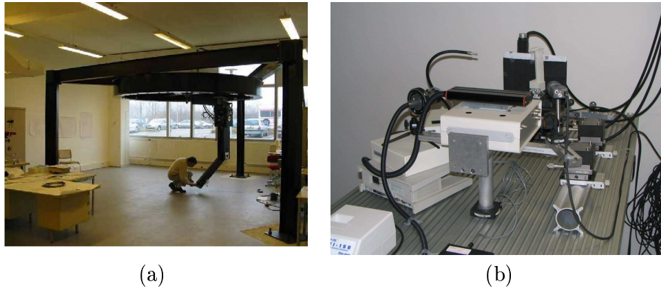
FIG. 4.2 – (a) Vue générale du robot de mesure (plate-forme d'acquisition). (b) Version prototype du robot de mesure.
