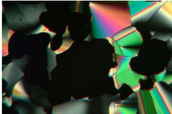
Figure 99 : Texture observée pour **D10** au POM à 117°C
