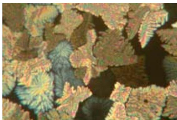
*Figure 57 : Texture observée pour **C14** au POM à 100°C à la première montée*
