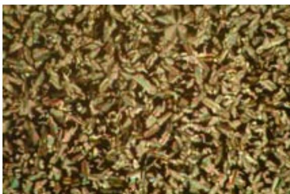
*Figure 56 : Cristallites observée pour **C19** au POM à 76°C*
