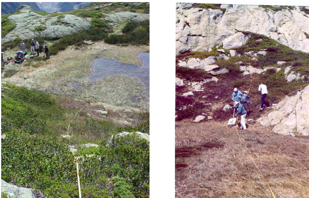
Figure 3 : a) Emplacement du profil traité dans la section I. Vue prise depuis la fin du profil. b) Acquisition des données sur ce profil, avec l'antenne blindée 250 MHz, à la jonction tourbière / éboulis.
