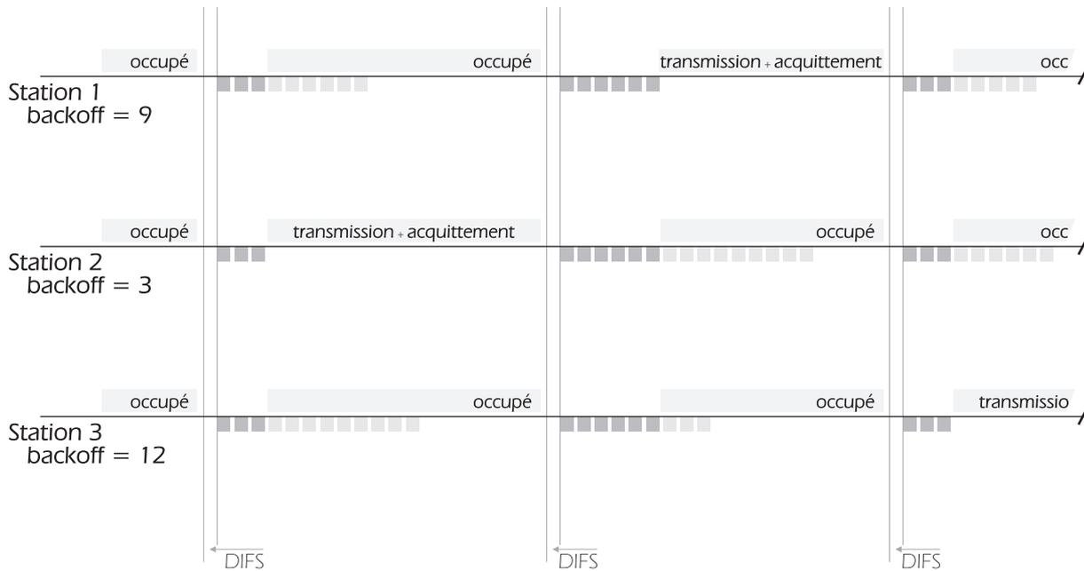
FIG. 4.2 – Exemple de déroulement du mécanisme DCF
