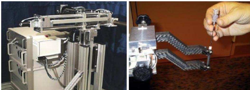
Fig. 3.9: Le B-Rob dans sa première version : (gauche) système de positionnement grossier, (droite) système NPU d'orientation et de positionnement passif de l'aiguille [KFK<sup>+</sup>03].
