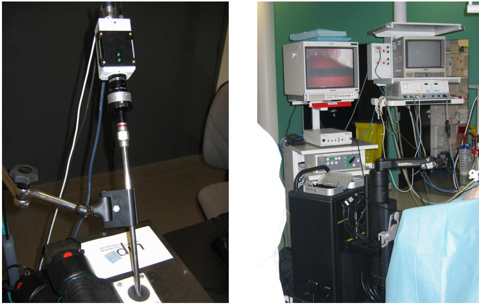
Fig. 3: Les caméras endoscopiques utilisées en chirurgie coelioscopique sont constituées d'une caméra classique sur laquelle est monté un tube rigide contenant un système de lentilles. A droite, le retour visuel fourni au chirurgien dans la salle d'opération de l'IRCAD à Strasbourg.
