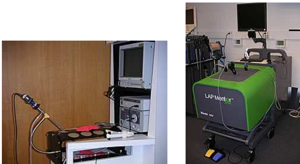
Fig. 1.3: Les systèmes BoxTrainer (à gauche) et LapMentor (à droite). Les interfaces se ressemblent, mais le BoxTrainer est un environnement de simulation synthétique utilisant des modèles plastiques, tandis que le LapMentor utilise un environnement virtuel.
