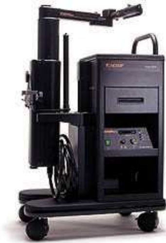
Fig. 1.8: Le système AESOP, constitué du bras robotique et de son contrôleur, monté sur un chariot.
