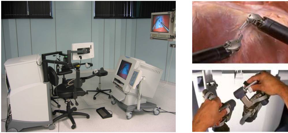
Fig. 1.15: La console maître du système Zeus de l'Ircad (Strasbourg). Les mouvements du chirurgien sont reproduits par les effecteurs du manipulateur esclave (photo du système da Vinci).
