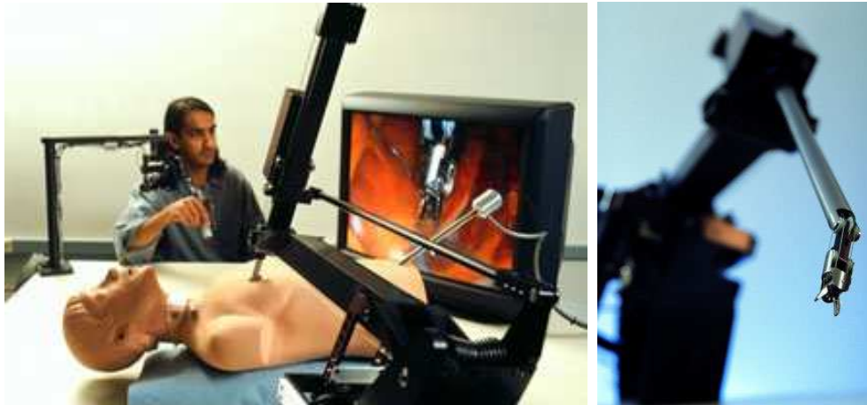
Fig. 1.13: Le système BlackFalcon. A gauche la console maître et le manipulateur esclave. A droite, les degrés de liberté supplémentaires en bout d'instrument.
