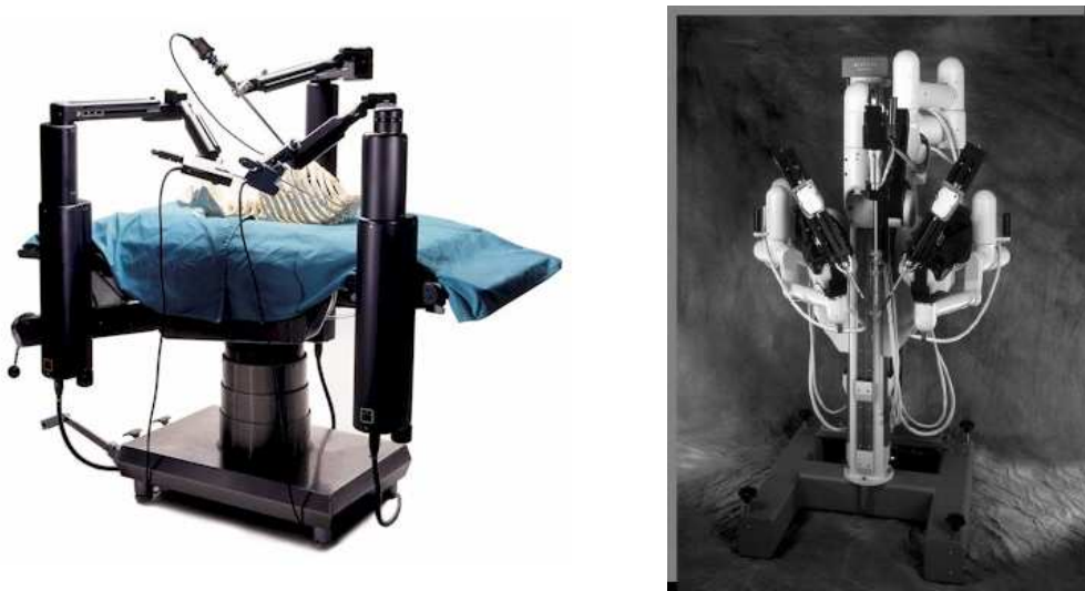
Fig. 1.11: Les manipulateurs esclaves des systèmes Zeus (à gauche) et da Vinci (à droite). Alors que les trois bras du système Zeus sont totalement indépendants et montés autour de la table d'opération, les trois bras du système da Vinci sont montés sur une base commune qui doit être fixée au-dessus de la table d'opération.
