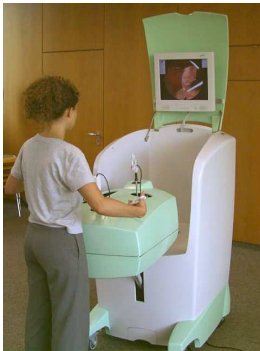
Fig. 1.4: Le système de simulation VSOne développé par le centre de recherche de Karlsruhe (FZK) est constitué d'une interface reproduisant les conditions de la chirurgie laparoscopique et d'un système de réalité virtuelle. Origine de la photo : Forschungszentrum Karlsruhe.
