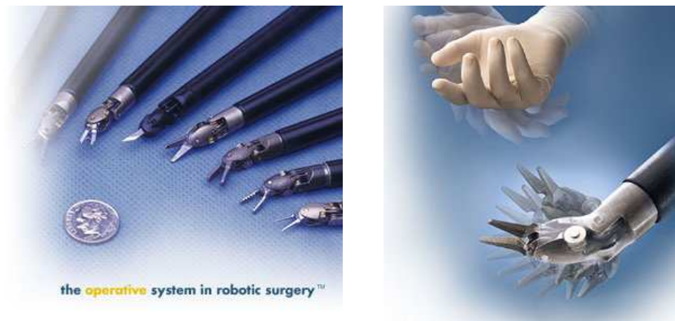
Fig. 1.12: Quelques instruments de la gamme EndoWrist disponibles avec le système da Vinci. Ils disposent de poignets à deux degrés de liberté permettant de reproduire à l'intérieur du corps les mouvements de la main du chirurgien.
