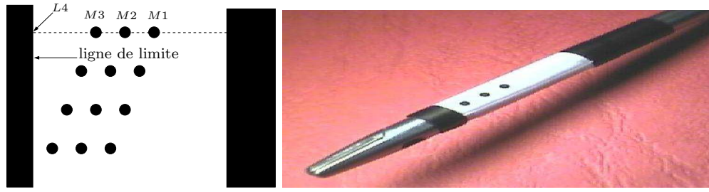
Fig. 4.2: A gauche : Principe du marquage utilisé pour l'instrument. M1, M2, M3 et L4 sont les points utilisés pour calculer le bi-rapport de la première ligne. A droite : le marqueur est enroulé autour du corps cylindrique du porte-aiguille, juste au-dessus des mâchoires.
