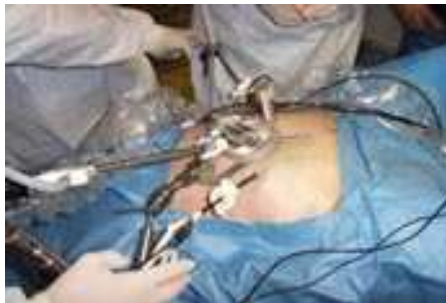
Fig. 1.10: Le système porte-endoscope LER développé par TIMC. La base du robot est directement posée sur le patient.
