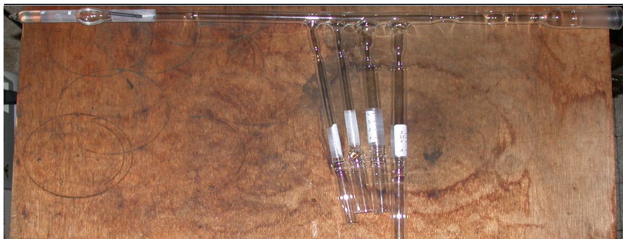
Figure A.7 Montage de type « diviseur ». Ici, le montage est utilisé pour diviser une ampoule de monomère.
