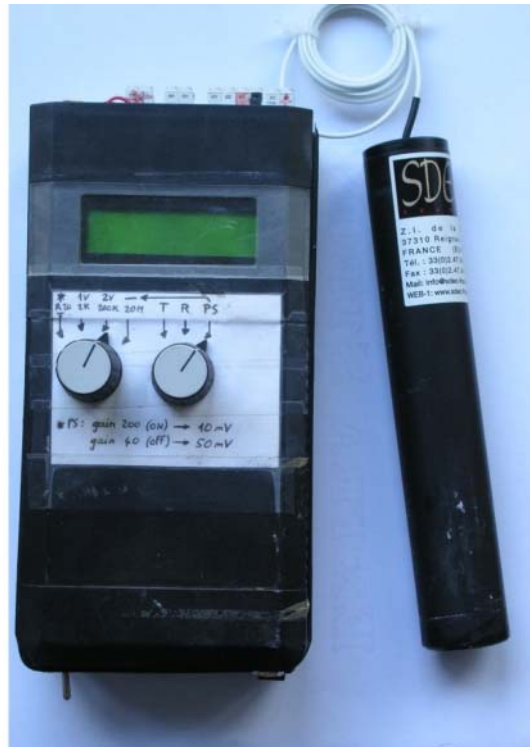
Figure 5.3 : Version 1.0 de la « Géobox ». La « Géobox » est voltmètre alternatif à haute impédance d'entrée dédié à la mesure de potentiels spontanés sur le terrain développé en collaboration avec Pierre-Daniel Matthey (EOST).
