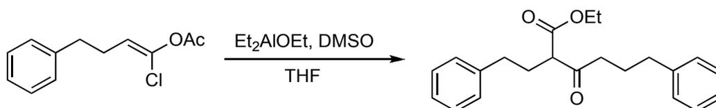
À une solution de triéthylaluminium (25% dans le toluène, 0,75 mL, 1,4 mmol), est additionné goutte-à-goutte de l'éthanol anhydre (73  $\mu\text{L}$ , 1,25 mmol), à -78 °C sous argon. Le mélange est réchauffé à température ambiante, puis dilué avec du THF anhydre (2,0 mL). À la solution d'éthoxyde de diéthylaluminium obtenue, est additionné l'acétate de (*Z*)-1-chloro-4-phénylbut-1-ényle **81** (50  $\mu\text{L}$ ,
