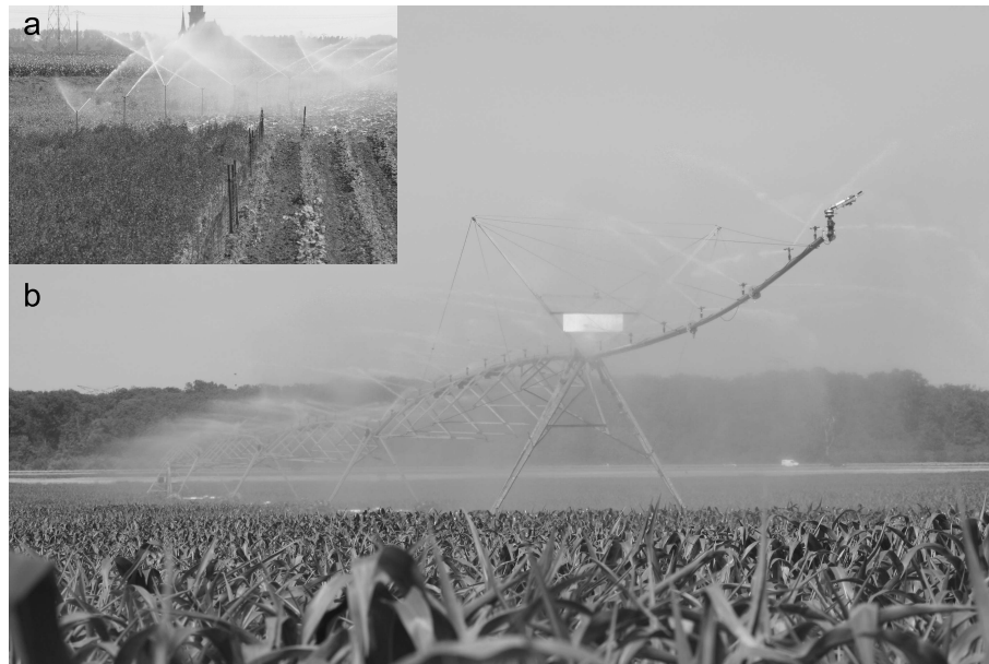
FIG. 5.2 – Dispositifs d’irrigation basés sur un réseau de gicleurs (a) ou sur un pivot motorisé (b) ( Alsace, 30 juin 2006 ).
