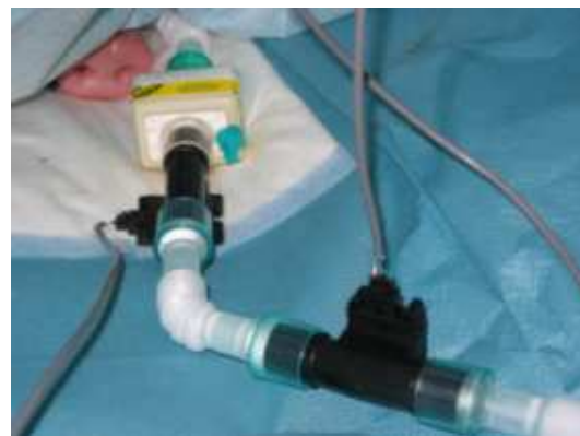
FIG. 3.3 – Deux débitmètres volumiques uni-directionnels AWM700 placés en série dans le circuit de ventilation
