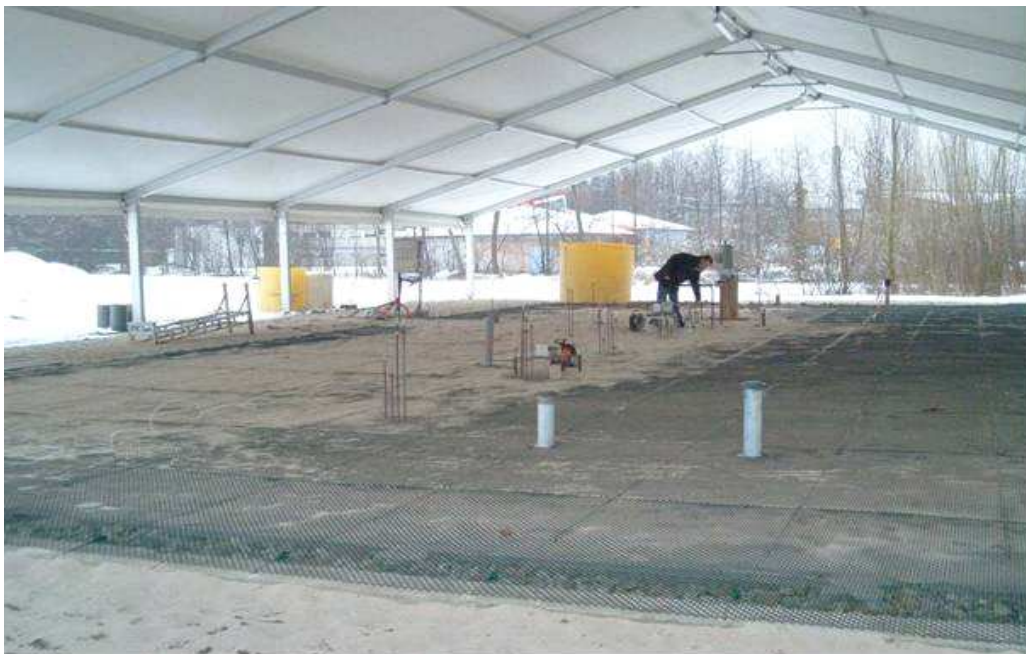
Figure 4-1: Le bassin SCERES avec le système de protection et de maintien de la couche superficielle
