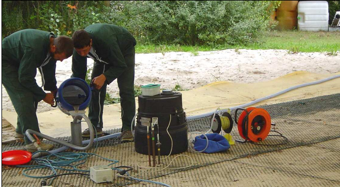
Figure 2-10: Injection du traceur dans le bac amont
