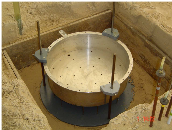
Figure 2-6: Dispositif d'injection dans la zone non saturée
