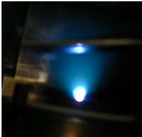
Figure III.2 : photo du plasma obtenu avec une cible de \text{Sr}_2\text{FeMoO}_6 . Le cône formé par le plasma est appelé panache (ou « plume » en anglais). Il contient tous les éléments de la cible sous forme ionique, atomique ou moléculaire.
