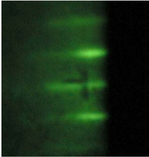
Figure III.20 : diagramme RHEED d'une couche de Sr_2FeMoO_6 d'épaisseur 70 nm, suivant l'azimut \langle 110 \rangle du Sr_2FeMoO_6 (ie. l'azimut \langle 100 \rangle du SrTiO_3 ). Les bâtonnets sont visibles pendant toute la durée du dépôt.
