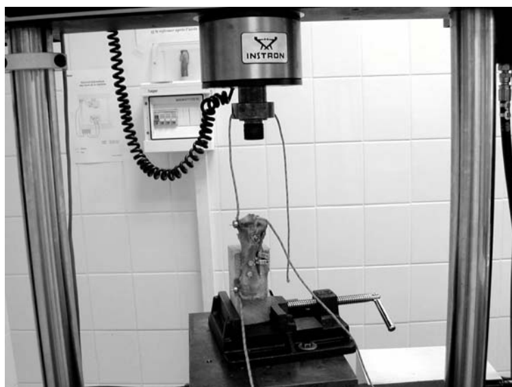
figure 15 : montage expérimental pour essai sur fracture tibiale proximale type 3 de Salter . La pièce anatomique est fixée sur une plaquette en bois serrée dans un étau fixé sur la presse hydraulique.
