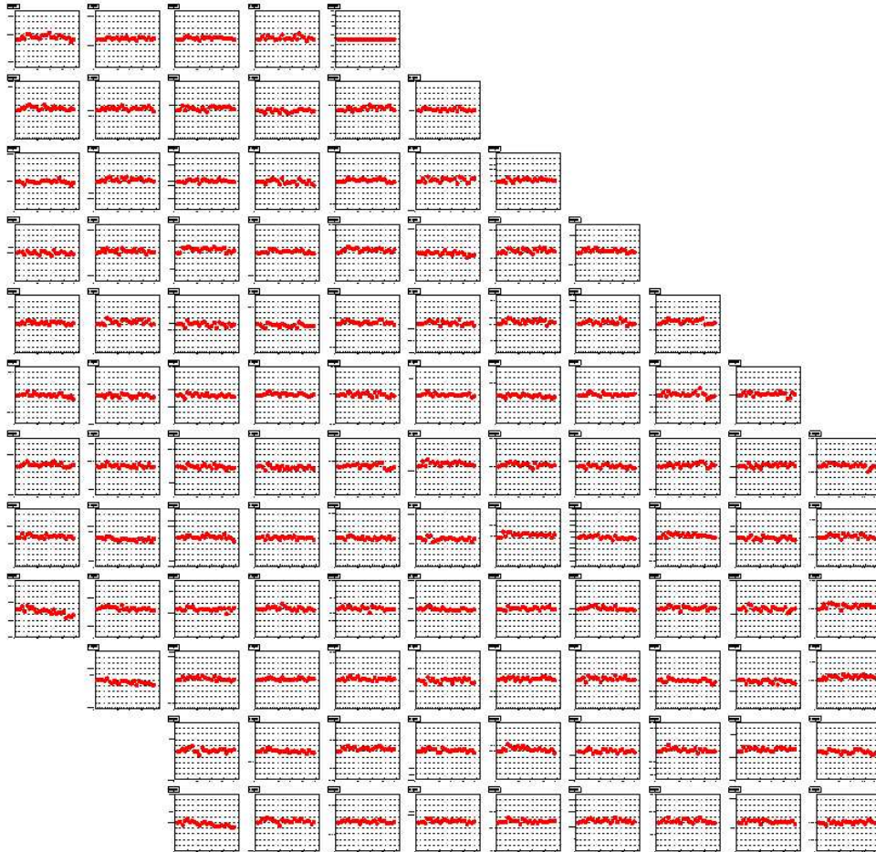
Figure 4.8: Historique des variations des gains pendant la durée de l'expérience, déduites des mesures laser (quadrant supérieur droit de IC). L'échelle verticale va de -25 à +25 %. La voie la plus à droite dans la rangée supérieure est la voie de référence. Noter la légère baisse de gain uniquement sur la couronne interne.
