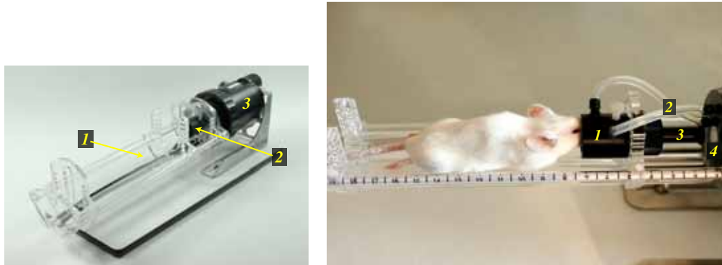
FIG. 4.2: Cellule d'imagerie développée pour le petit animal. Partie gauche : (1) lit réglable en hauteur et en profondeur, (2) masque dispensant les gaz anesthésiques et système de fixation par barre de dents, (3) corps de chauffe, canal technique, réglage des débits d'aspiration Partie droite : (1) masque, (2) arrivée et extraction de gaz, (3) réglage des barres de dent, (4) canal technique
