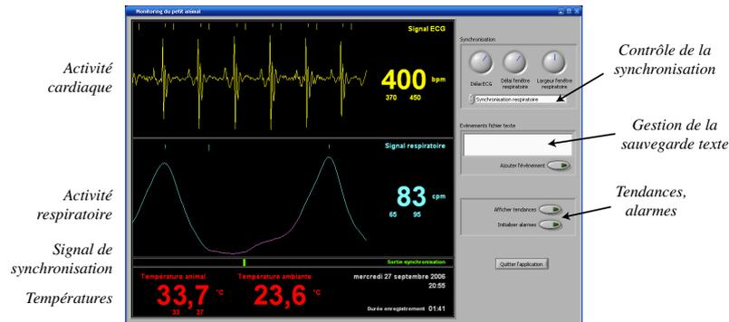
FIG. 4.4: Interface du module de surveillance des paramètres physiologiques du petit animal au cours de l'acquisition.
