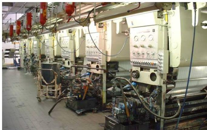
**Photo n° 3 : Rangée d'éléments d'imprimeuse, une couleur par élément**
