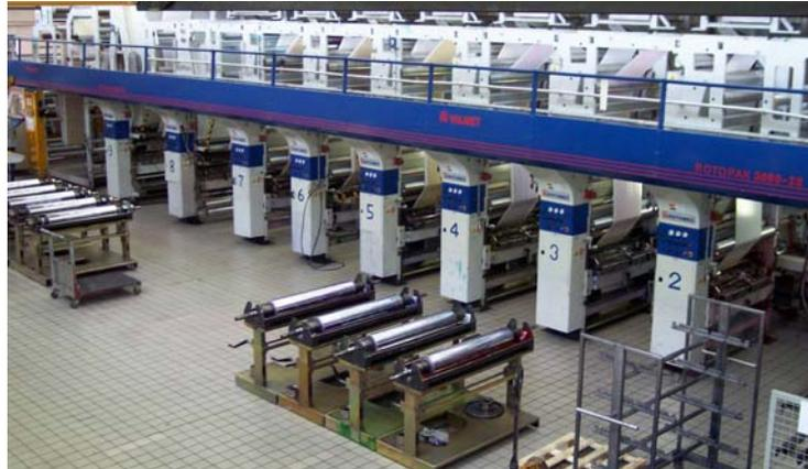
**Photo n° 1 : Imprimeuse d'héliogravure à 10 éléments**
