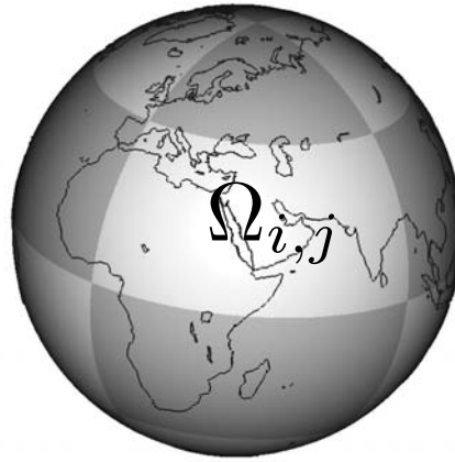
FIG. 4.10 – Subdivision d’une couche \Omega du maillage régulier, en 16 sous-domaines.
