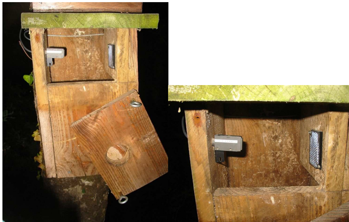
Figure 21: photos de la disposition des capteurs infrarouges à l'entrée des nichoirs.
