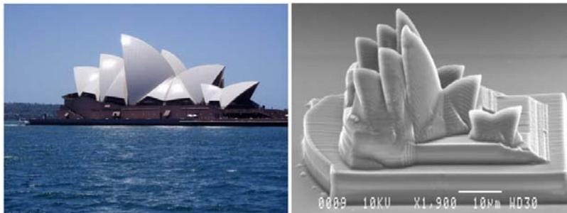
**Figure 14** Micro-modèle de l'opéra de Sydney fabriqué en polysiloxane par photopolymérisation à deux photons.
