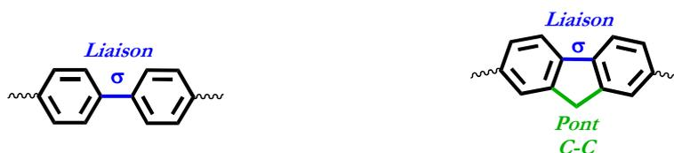
**Figure 28** Structure du groupement biphényle (à gauche) et du groupement fluorène (à droite).
