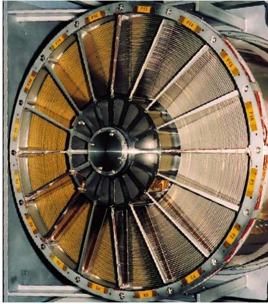
FIG. 1.9 – Miroirs des télescopes d'*XMM-Newton*. Notez les coquilles qui permettent de focaliser les rayons X (crédits Dornier Satellitensysteme GmbH & ESA).
