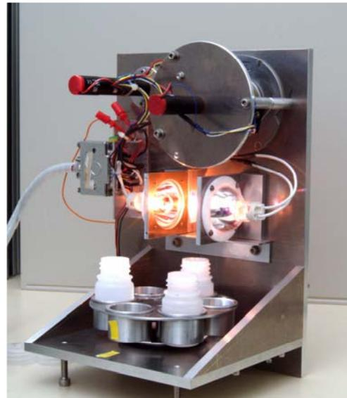
Figure IV.1 : *Automate utilisé pour élaborer les couches de nanobilles de silice. Conception et réalisation J.P. Hoessler et J. Stoll*
